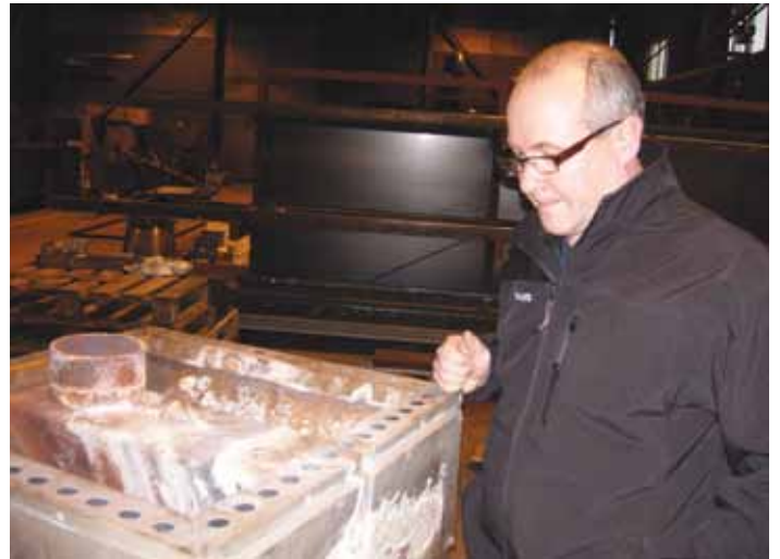
Teräksen lehteilyä ja kalkin aiheuttamaa tuhoa. Kuvassa korjauksessa oleva kiuas ja Rauno.
